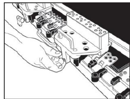
6. Подправьте ударами молотка верхнюю часть полосы соединителей. Поместите направляющие блоки SR700 на концах полосы соединителей и затяните фиксирующие винты. Смажьте направляющие блоки смазкой SL5 Silicon.
