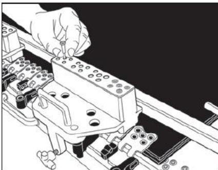
7. Поместите заклепки в направляющий блок. Вы можете уменьшить время монтажа соединения, установив дополнительные направляющие блоки.
