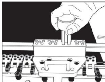
8. Используя пробойники SR759 (SR759-2 для R2) протолкните заклепки в направляющий блок. С помощью молотка 1,8 кг начните клепку с края полосы соединителей.
