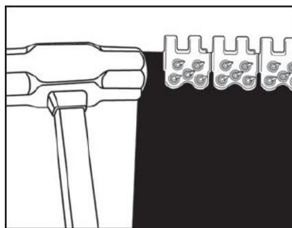
11. Удалите калибровочный стержень и снимите зажимную планку. Поднимите устройство, удалите оставшиеся пилотные штыри. Переверните монтажное устройство и удалите из отверстий станины "штыри" заклепок.
