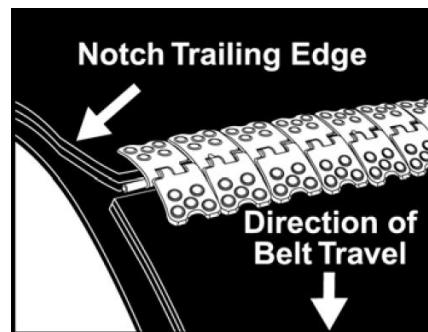
12. Повторите шаги 1-11 с другим краем ленты. Соедините края ленты вместе и вставьте шарнирный стержень. Край ленты по ходу движения с обеих сторон обрезают под небольшим углом по длине 7,5- 8 см, для того чтобы лента не задевала за ролики. Соединение выполнено.
