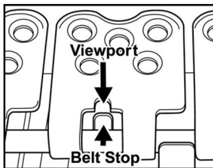
5. Установите край ленты в полосу соединителей. Используйте точку обзора для точной установки края ленты прямо напротив упора. Затяните зажимную планку для фиксации транспортерной ленты.
