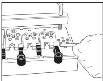
4. Установите полосу соединителей на устройстве, логотипом Flexco вверх. Отверстия на соединителях и станине должны совпадать. Вставьте калибровочный стержень сквозь направляющие и петли звеньев соединителей.
