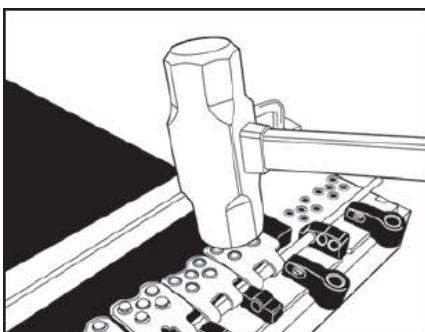
10. Удалите направляющие блоки. Используя молоток 1,8 кг подбейте все заклепки и пластины соединителей. Поверхность ленты должна всучиться вокруг кромки соединителей.
