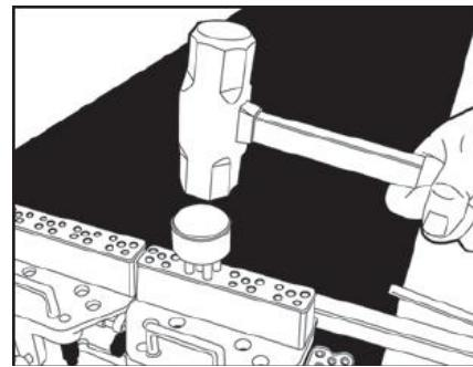
9. Расклепайте заклепки в центральной части. Переустановите направляющий блок, загрузите заклепки и расклепайте их в оставшихся пластинах.
